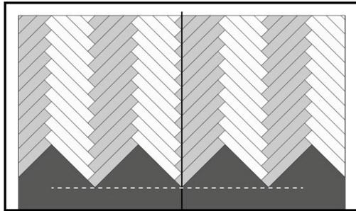
Kontrollieren Sie regelmäßig, dass die äußeren Ecken der Dreiecke immer auf einer Linie liegen. Wenn eine Fuge entsteht, demontieren Sie einige Planken bis an die Stelle des Fehlers zurück und verlegen Sie diese erneut.
