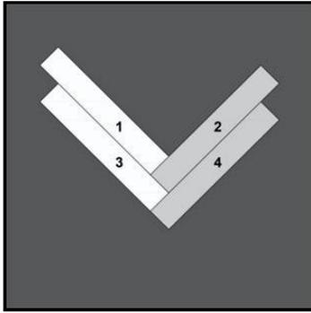
3. **Setzen Sie eine zweite L-Planke** (Nr. 3) mit ihrer langen Seite in die lange Seite der zuvor verlegten L-Planke (Nr. 1) und in die kurze Seite der ersten verlegten R-Planke (Nr. 2) gemäß dem Nut-Feder-System ein. Vergewissern Sie sich, dass die Nut an der kurzen Seite der zweiten L-Planke (Nr. 3) eine gerade Linie in Bezug auf die Nutseite (an der langen Seite) der ersten R-Planke (Nr. 2) bildet.
