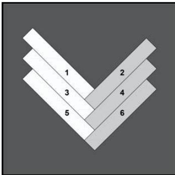
4. **Dann wird eine zweite R-Planke** (Nr. 4) mit seiner langen Seite in die lange Seite des zuvor verlegten R-Planke (Nr. 2) und in die kurze Seite des zuvor verlegten zweiten L-Planke (Nr. 3) nach dem Nut-und-Feder-System eingesetzt. Achten Sie darauf, dass die Nut an der kurzen Seite der zweiten R-Planke (Nr. 4) eine gerade Linie mit der Nut an der langen Seite der zuletzt montierten L-Planke (Nr. 3) bildet.
